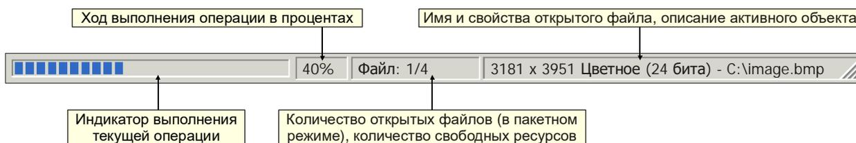
Рисунок – Информационная панель (строка состояния)
